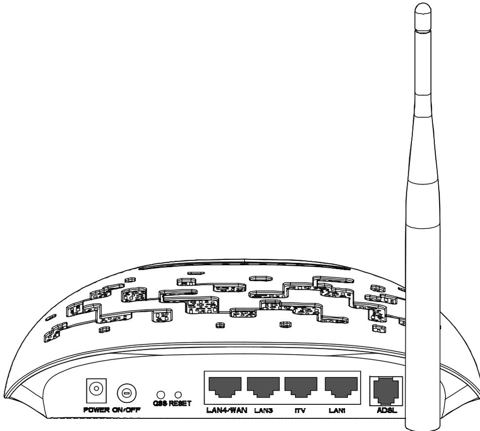
图 2 TD-W89741N 后面板示意图
