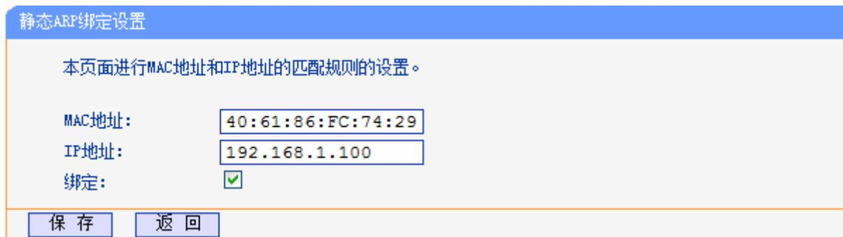
图 84 添加静态 ARP 绑定条目
