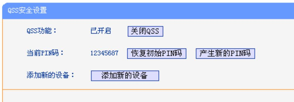
4. 在随后出现的界面中选择“输入准备添加的新设备的 PIN 码”，在下方的 PIN 码框中输入在第 2 步记录的 8 位网卡 PIN 码，然后点击**连接**按钮。
