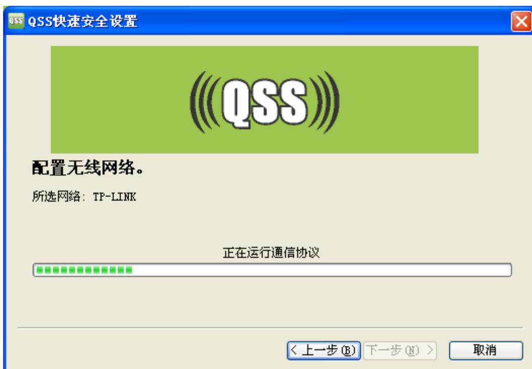
4. 出现下图所示界面则表示网卡端快速安全连接配置成功，单击**完成**结束。
